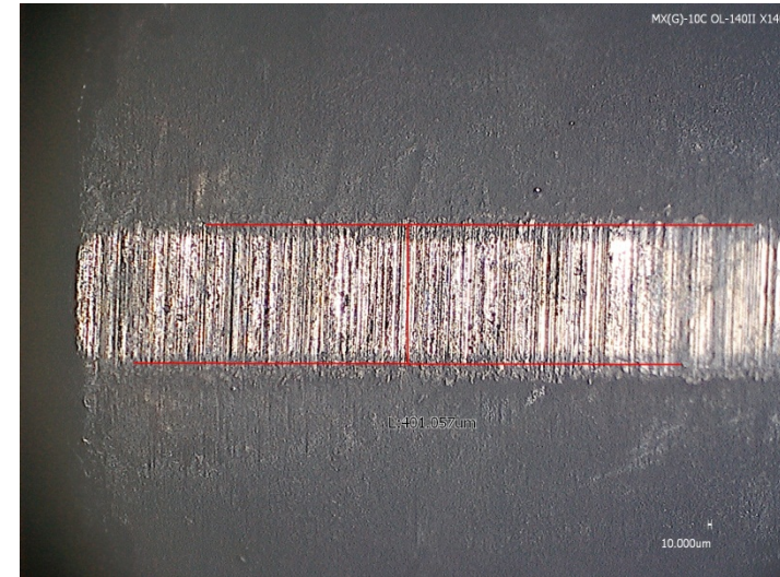
Gegenkörper, 1.3505, 48HRC, Ra 0,1µm, unbeschichtet
